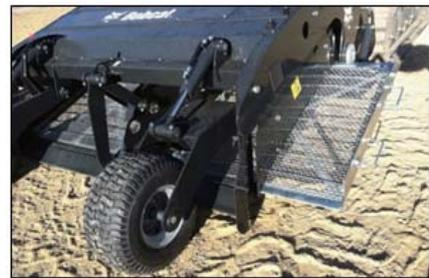
本体の後部にバックブレードを取り付ければレーキのように地面を均一にすることが可能です。グラウンドの小石回収後の整備などに。
